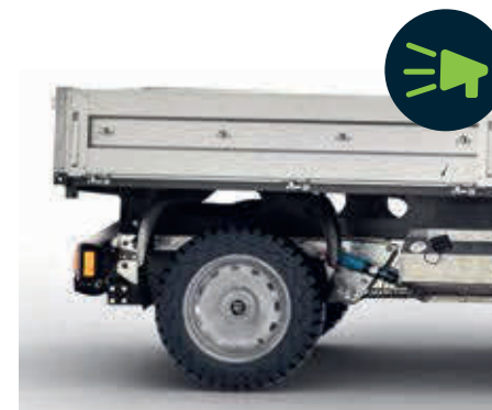
Rückfahrwarner Auditives Signal bei eingelegtem Rückwärtsgang. Warnt Personen in der Umgebung und trägt somit zur Unfallvermeidung bei.
