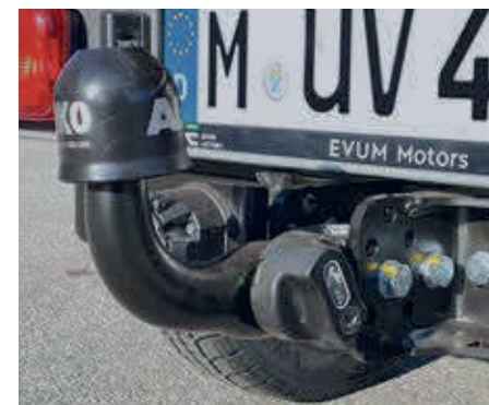
Abnehmbare Anhängerkupplung Gebremst 1.500 kg / ungebremst 750 kg / 70 kg Stützlast.
