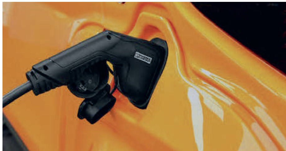
Starkstromladen: Wallbox inkl. Schnellladekabel Verkürzt die Ladezeit des aCars. Laden mit bis zu 9 kW (0–80 % in ca. 2,5 Stunden, 0–100 % in 3,1 Stunden bei 16,5 kWh Akku). CCS Laden an öffentlichen Ladesäulen ist nicht möglich.
