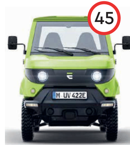
Drosselung auf 45 km/h Auf individuelle Bedarfe hin können wir die Fahrzeuggeschwindigkeit drosseln. Z.B. auf 45 km/h.
